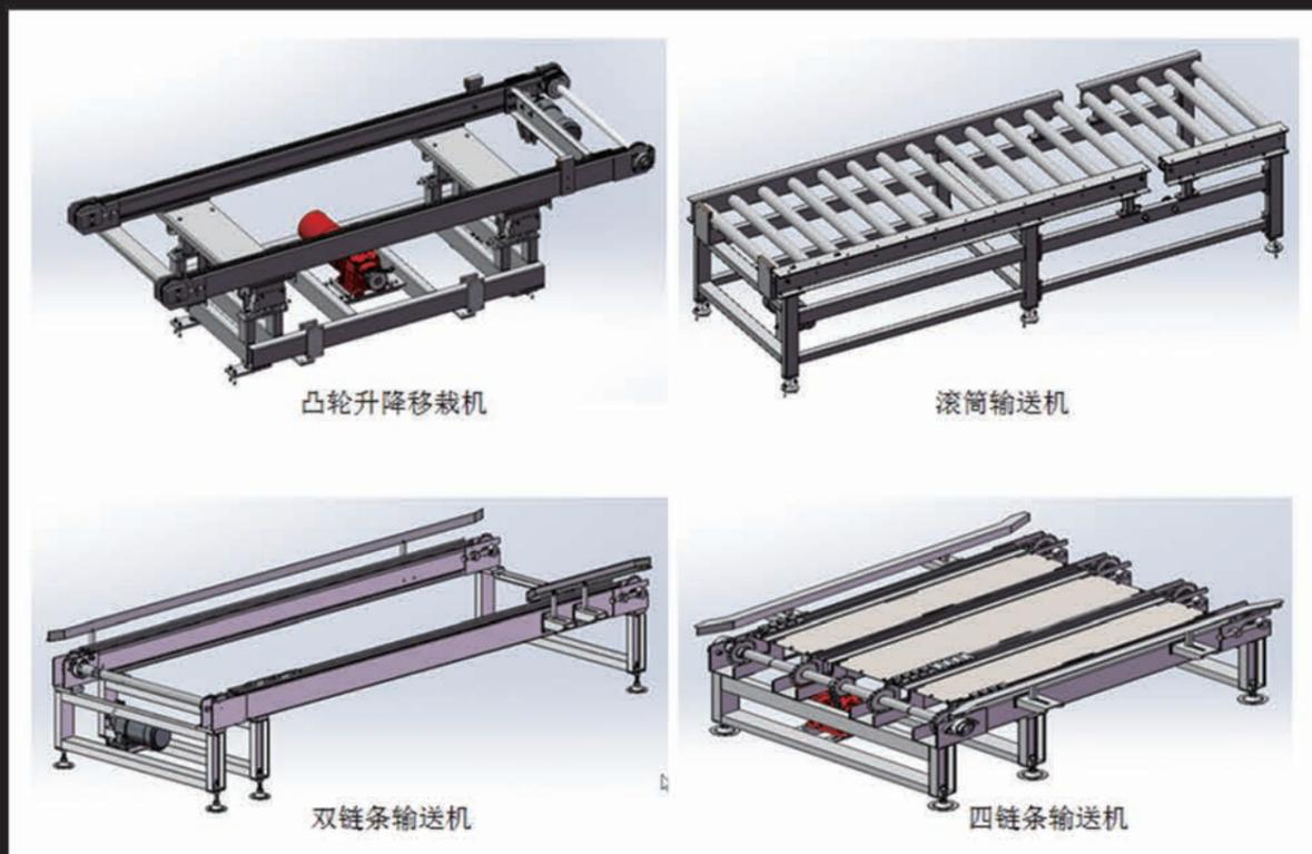
RGV，是有轨引导车辆（Rail Guided Vehicle）的英文缩写，又叫有轨穿梭小车。RGV小车与穿梭板配合使用可用于各类高密度储存的立体仓库或是多巷道立体仓库输送系统的物流分配。根据托盘的结构型式，RGV车载输送系统可配置滚筒输送机、链条输送机、皮带输送机、升降货叉等。
