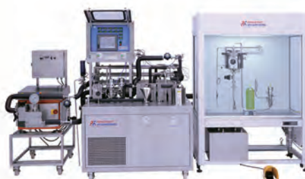
实验室微型超高温/UHT生产线
