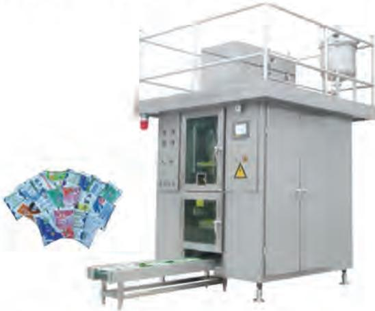
该机适合于牛奶、豆奶、花生奶、果汁等产品的无菌包装。自动完成制袋、充填封口、日期打印、计数、供袋清洗等功能。人机界面,可编程控制、气动、伺服电机驱动,先进的杀菌与无菌保障。其人机界面、PLC、光电、气动、润滑、无菌处理、伺服等系统和各种阀体均采用国际知名品牌。304、316、材料卫生安全保证。
