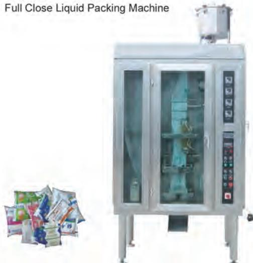
全封闭自动液体包装机:适用于牛奶、豆奶、花生奶、果奶、果汁、饮料、酱油、醋酸等液态食品的全自动袋式包装。本机内制袋、灌装、封口、计数、打印日期、紫外线杀菌一次性全自动完成。
