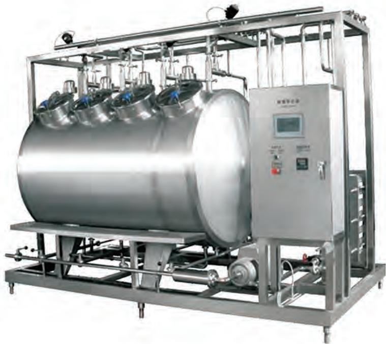
CIP清洗系统是食品、药品生产中卫生标准的前提条件之一，它可以消除活性成分交叉污染，消除异物不溶性微粒，降低或消除微生物及热源对产品的污染。GMP要求尽力推荐食品及制药企业使用CIP在线清洗系统，由于国外全自动CIP清洗系统价格昂贵，制约了我国相关企业的使用。我公司专业技术人员针对诸多问题，对引进的国外先进技术进行消化吸收，研制成功具有自动化程度高，操作简便，价格合理等优点的自动CIP清洗系统。
