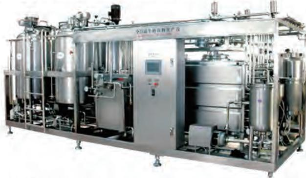
多功能牛奶饮料生产系统采用最先进的技术, 集水处理、制冷缸, 调配罐、待装罐、剪切罐、均质机、高温管式杀菌机、胶体磨、灌装机、制冷机, 空压机, 电锅炉, CIP清洗机为一体的多功能生产机组, 从该系统出来可直接接到灌装机械上进行灌装。设备结构合理, 造型美观, 能大大节省生产场地的空间, 一个工人即可操作生产, 低成本的维护保养, 零件标准化, 替代品本地化。多功能牛奶饮料生产线可生产鲜奶、巴氏奶、酸奶、果味型酸奶、果汁、调配型果汁、茶饮料、雪糕冰淇淋等。所有电器及配件均采用国际名牌产品。生产线结构为不锈钢。
